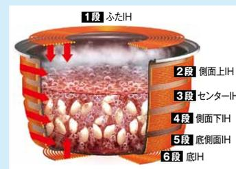
最新のIH炊飯器では、底部、側面、蓋面にIHコイルを設置することで、繊細な温度制御を実現し、それぞれの調理工程に最適な加熱が行えるように工夫されている。
