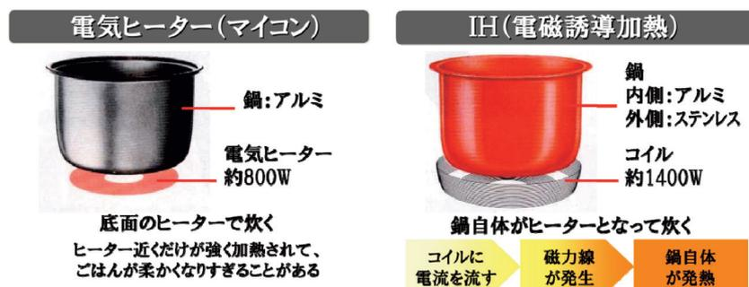
図3 ヒーター式とIH式の比較
