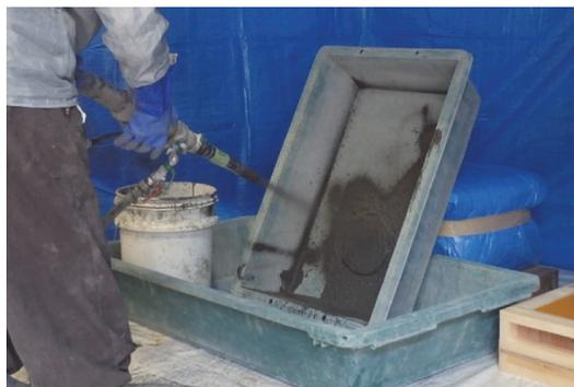
写真16 吹付け実験の状況
