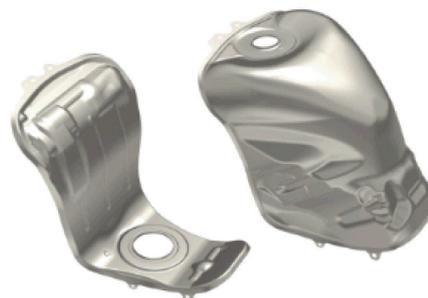
図19 CBR1000RRに搭載されたTP270C製燃料タンク構造イメージ図 (図提供：本田技術研究所 (株))
