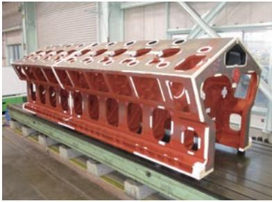
シリンダブロックは、従来は片状黒鉛鋳鉄 (FC300) が採用されることが多かったが、近年は軽量化のため球状黒鉛鋳鉄 (FCD500) の採用が増えている。
