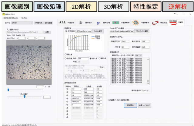
図2 遺伝的アルゴリズムによる逆解析 (特性→組織候補) (MIPHA)
