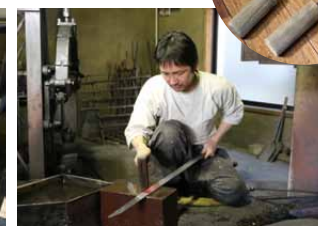
手槌で刃を薄く打ち出し、刀の形をつくる「火造り」の工程
