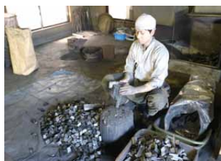
刀匠の修業で最初に行う「炭切り」の作業
