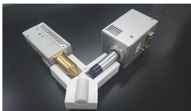
図1 3Dプリンタ製のX線分析装置。左が数ワットのX線管、右がSDD検出器。Y字の高さは11cm、横幅は8cm。
