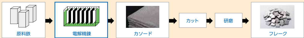
■電解鉄の生産工程(図2)
