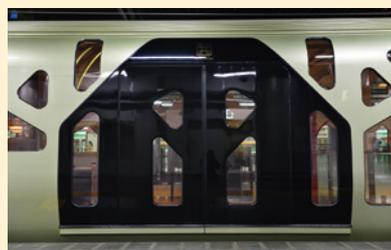
ラウンジカーの前後の台車間は低床のバスタブ構造で、両開きの乗降口となっている。
