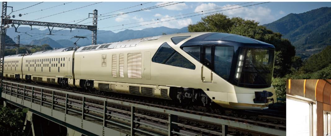
自然の景観をイメージした特徴あるデザインの先頭車両。外観は大型の三次元曲面ガラスで構成されている。
