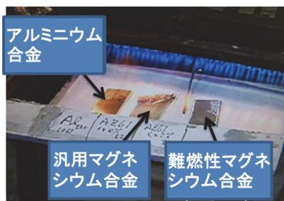
図6 ガスバーナー直火加熱試験による難燃性確認試験の外観
