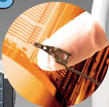
サーバーなどのハードディスクドライブにはステンレス箔を用いたサスペンションが使用されている
