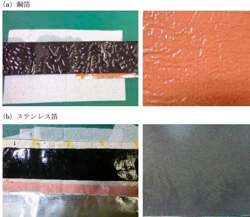
図18 (a) 銅箔と (b) ステンレス箔を用いた大型SiO電極のサイクル後の外観
