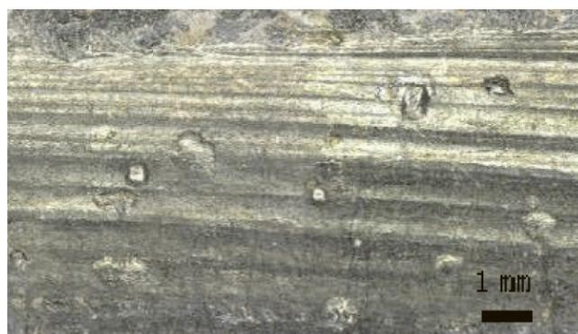
写真1 ビード表面に発生する鉄粒
