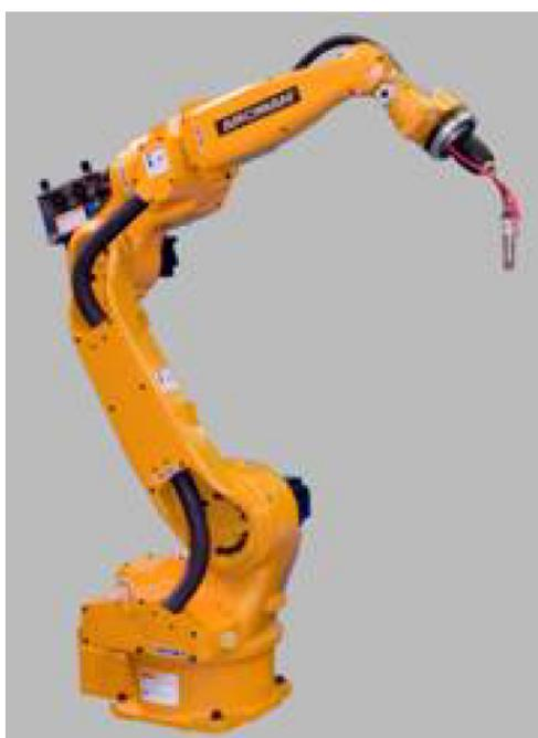
図21 ケーブル内蔵型マニピュレータ
