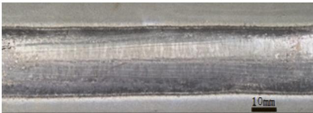
写真2 開発フラックスを用いた溶接ビード外観例
