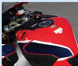
燃料タンクの外観(チタンタンクが樹脂製のタンクカバーで覆われている)
