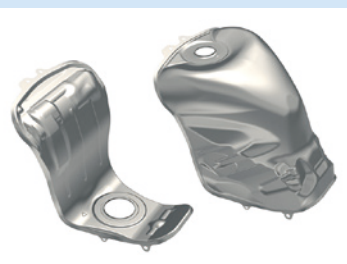
耐食性が高いチタンは無塗装で使用される。 写真右がタンク上部、左が底面
