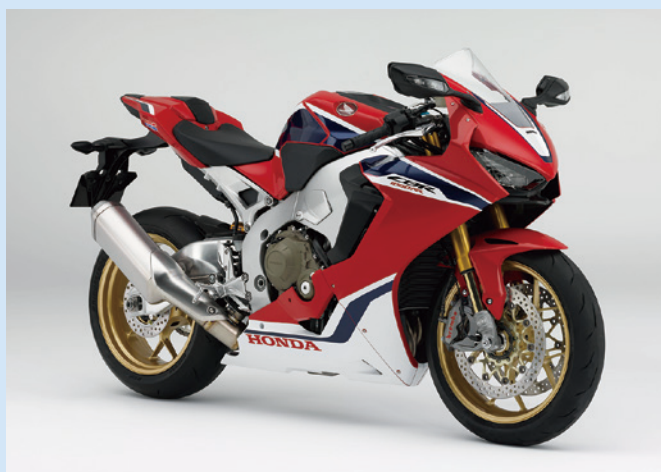
ホンダ「CBR1000 RR SP」1000cc チタン製タンクをはじめとした軽量化によって、オートバイ全体ではクラス最軽量となる195kgを実現している。
