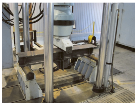
(a) ブロック変動荷重（三転曲げ）を受ける構造要素試験体
