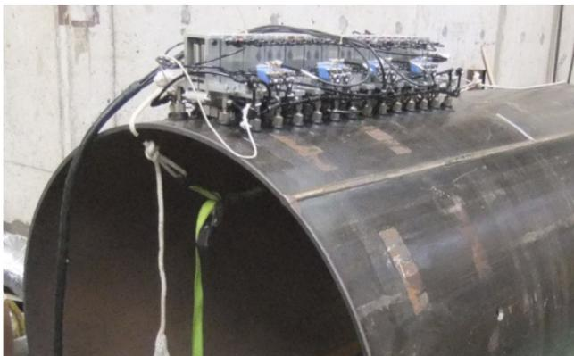
図6 圧電式ガイド波励起検出装置部
