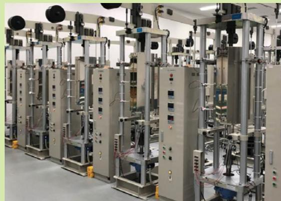
大型クリープ試験装置では高クロム鋼配管溶接部の
