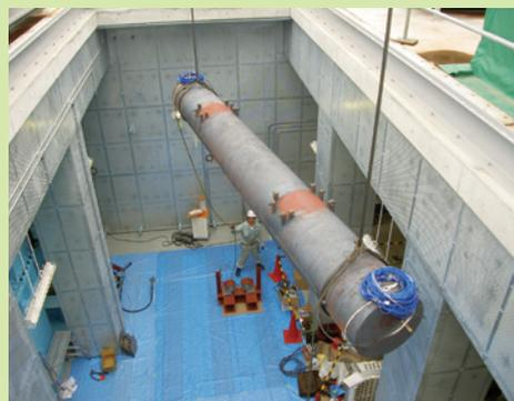
大型の試験体はクレーンでつり下げ、地上部を開口して試験室に搬入される。
