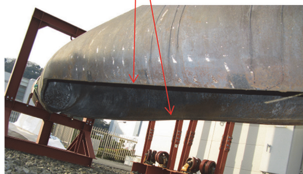
図9 破壊した実機配管試験体（Grade 91鋼溶接鋼管）
