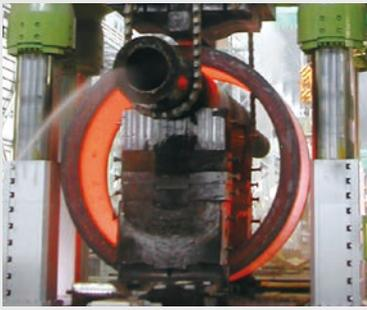
14000t油圧プレスによる鍛錬(図8)
