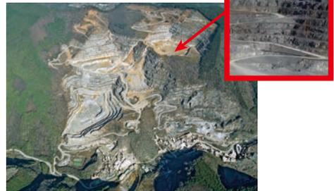
高さ約10mの階段状に採掘するベンチカット法と呼ばれる露天掘りが行われている(栃木県三峰山)。
