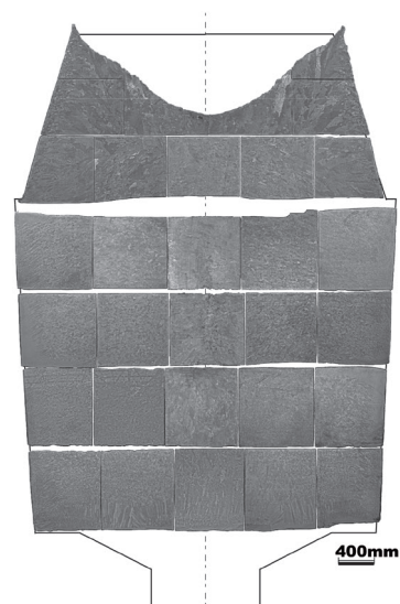
図9 650ton鋼塊の縦断面マクロ組織
