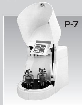
●通常の容器、雰囲気制御容器ともボールも含めて次ぎの材質を御使用いただけます。メノー、アルミナ、ジルコニア、チッカ珪素、ステンレス、クローム、タングステンカーバイト、プラスチックポリアミド ●容器のサイズ。500, 250, 80, 45, 12cc。
