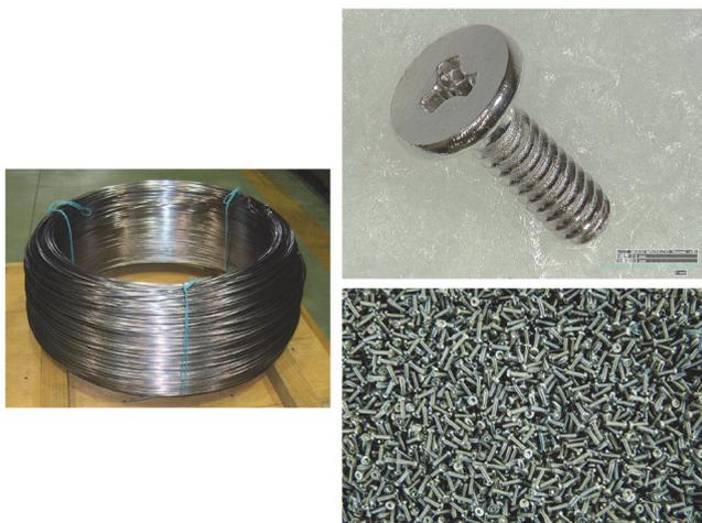
図10 超微細粒組織線材とその線材から製造されたM1.7マイクロねじ
