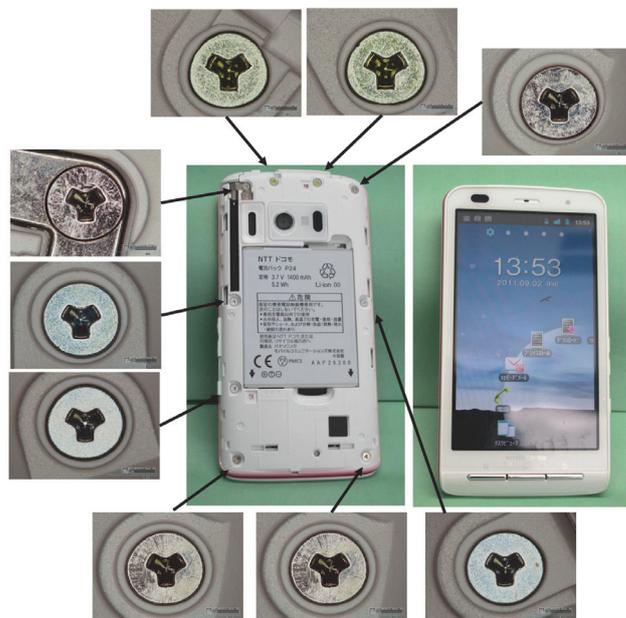
図11 パナソニックスマートフォンと採用された超微細組織マイクロねじ
