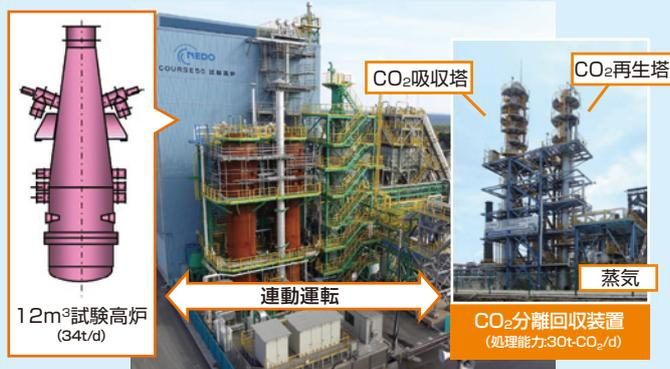
試験高炉とCO<sub>2</sub>分離回収装置を連動運転することにより、CO<sub>2</sub>排出の削減試験を進めている。(日本製鉄(株)君津製鉄所構内)
