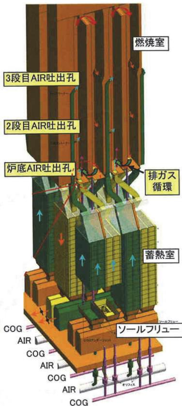
図1 多段燃焼構造(空気3段吹込み)
