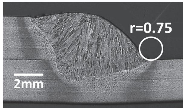
図8 重ね継手アーク溶接部の断面写真例。rは止端部の曲率半径
