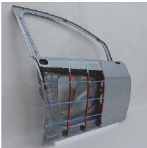
図7 極薄ハイテン外板を適用した新鋼製ドアの試作品
