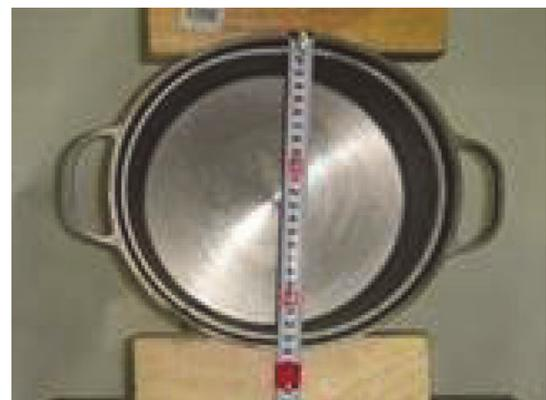
図7 10.3mm潰れたところで亀裂が入ったねずみ鑄鉄製鍋
