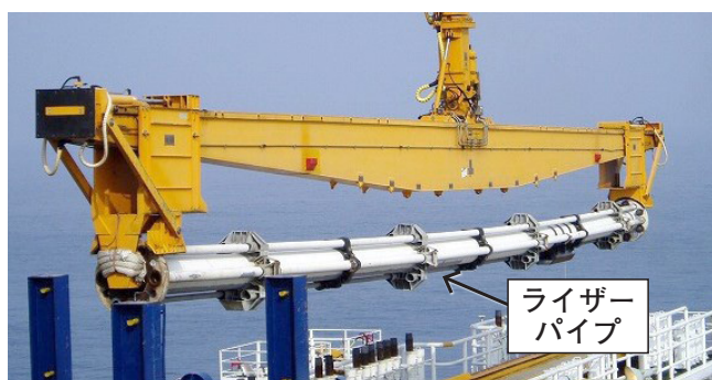
図5 浮力体なしライザーパイプ
