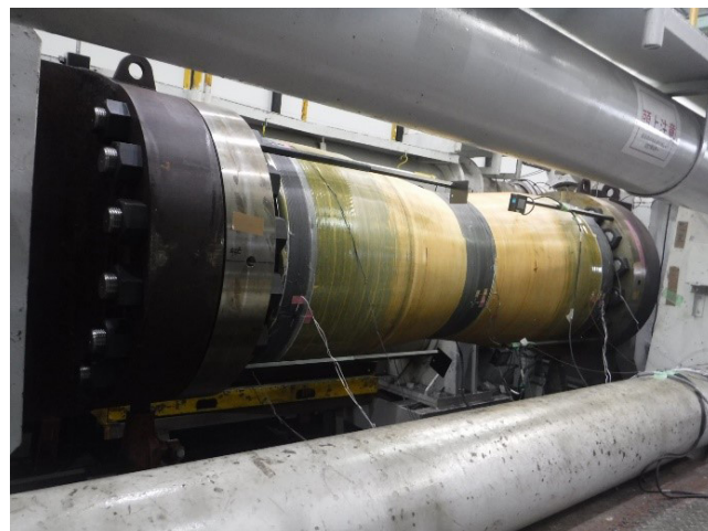
図11 CFRPライザーの試験体の引張試験
