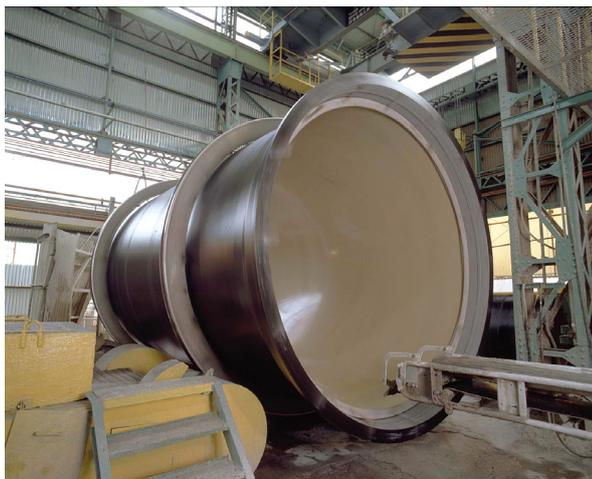
図14 モルタルライニング施工状況
