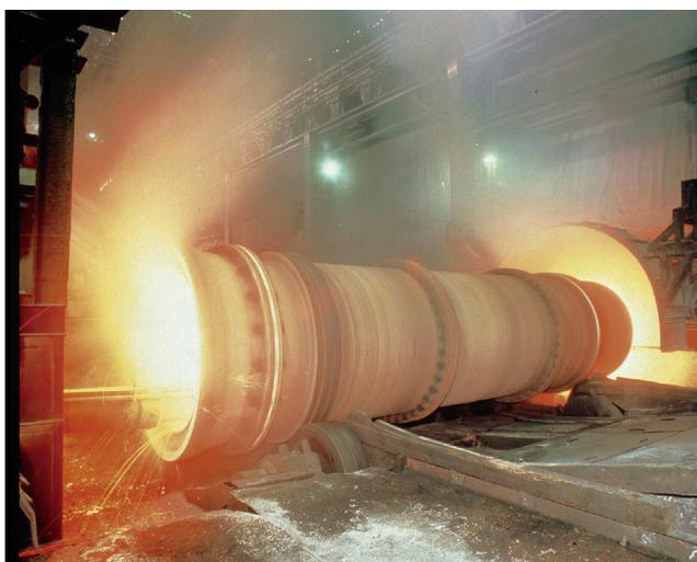
図7 ウェットスプレー遠心力 casting
