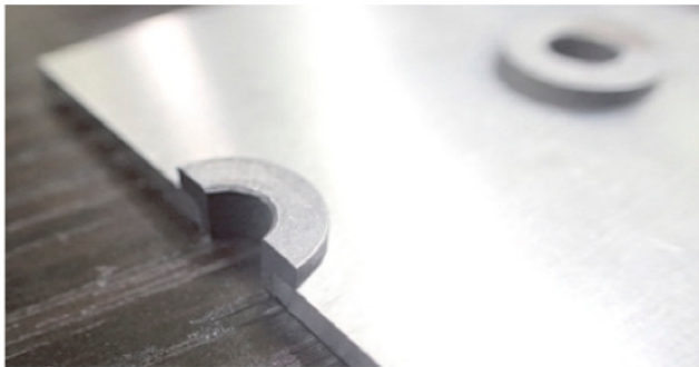
写真4 パンチング式で仮固定されたエレメント
