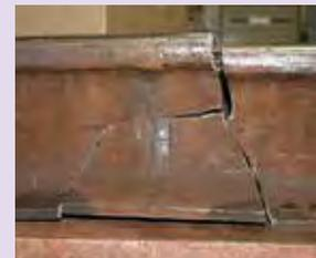
溶接部の折損(図9)
