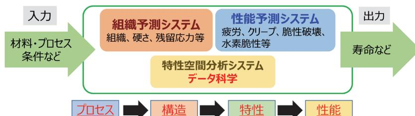
図7 マテリアルズインテグレーション (MI) システムの概念
