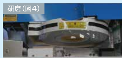
研磨(図4) 回転する研磨盤が上部に設置され、研磨面上にした試料が下方から研磨盤に押し付けられる構造になっている。
