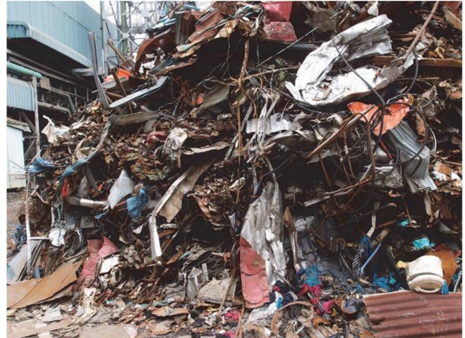
図3 電炉製鉄の原料となる鉄スクラップ（筆者撮影）
