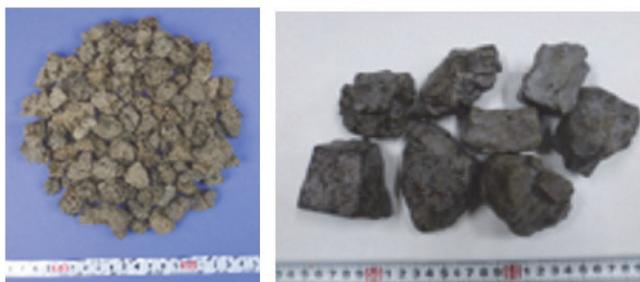
図7 粒度調整鉄鋼スラグ資材 (マリンストーン®) の外観
