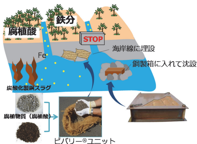
図2 陸域およびビバリー®ユニットによる鉄分供給
