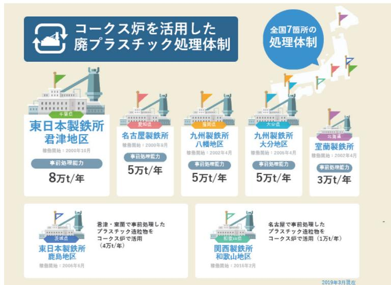
図8 日本製鉄（株）におけるコークス炉を利用した廃プラスチック処理体制
