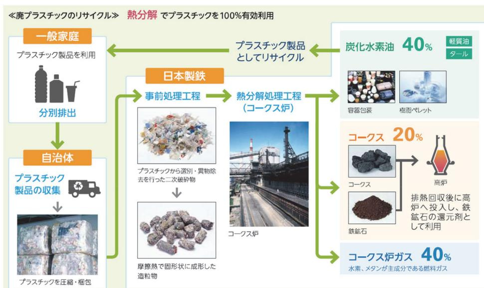
図7 コークス炉化学原料化法の概要
