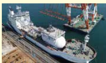
液化水素運搬船への液化水素タンク搭載
