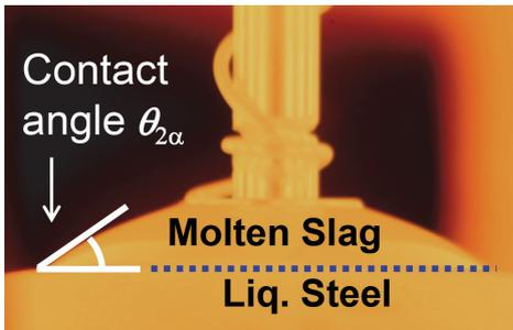
図1 溶鋼表面上に落下したスラグ液滴の接触角
