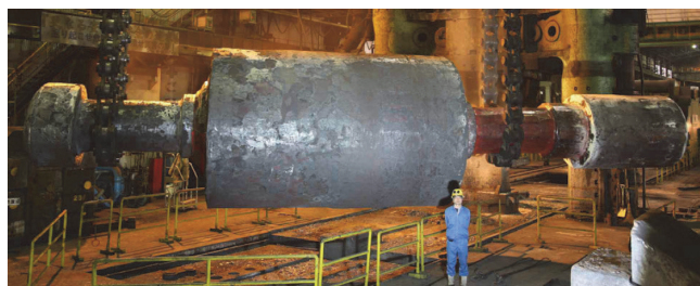
図1 タービンロータ軸材の鍛錬打上後の外観
