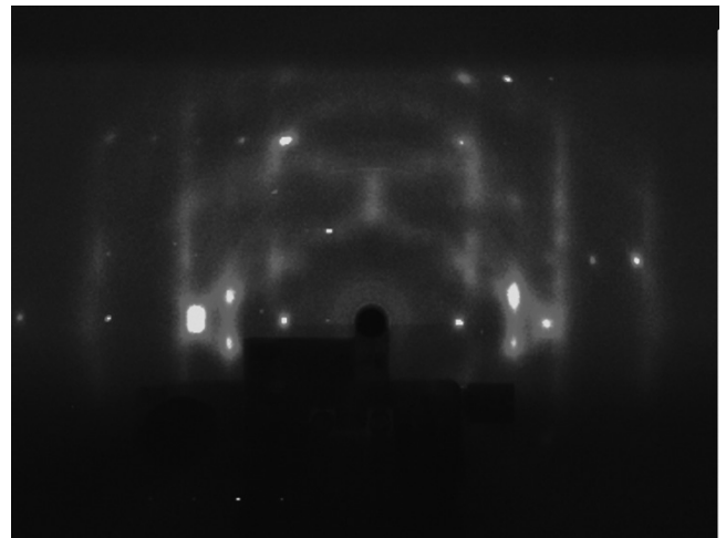
図3 2CaO · SiO 2 -3CaO · P 2 O 5 系の融体から晶出した固相の高温その場2次元X線回折図（文献11）より転載）
