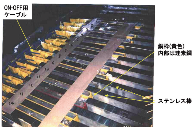
図8 磁気制御の可能性を確認するための手作りの試験装置
