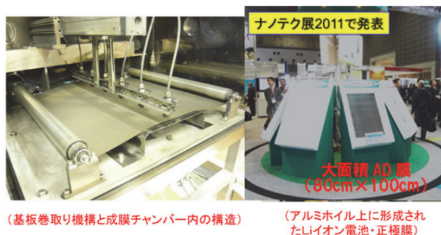
図9 ロール・ツー・ロール方式による大面積ADコーティング
