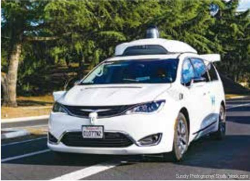
360度の3D空間構造を読み取る「LiDAR(Light Detection and Ranging)」によって道路情報を収集している。
