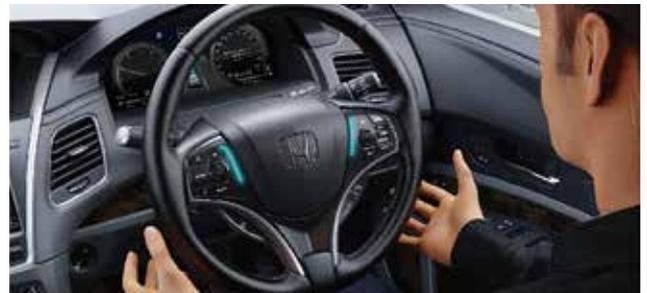
2020年11月、世界初となる自動運転レベル3型式指定を国土交通省から取得し、2021年3月には自動運行装置である「トラフィックジャムパイロット」(渋滞運転機能)を搭載したクルマが発売された。これにより高速道路渋滞時など一定の条件下で、ドライバーに代わってシステムが運転操作を行うことが可能となる
