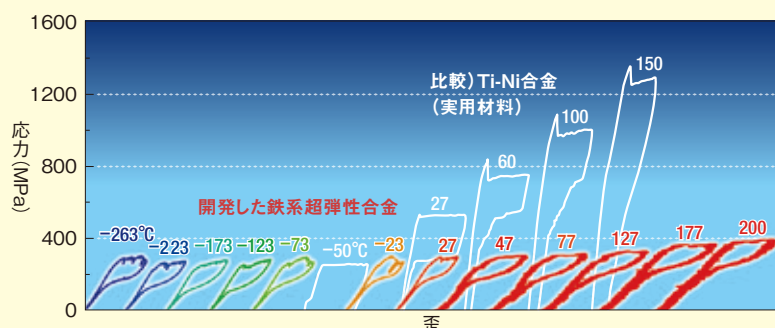
図2 温度依存性のない鉄系超弾性合金の特長
