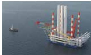
SEP船には現場での作業に加え、風車部材を建設現場まで運搬する役割も要求される。図は風車部材を積載した場合のイメージ図。
