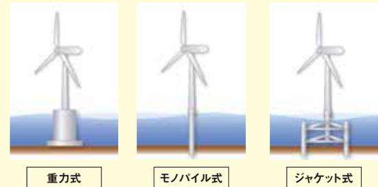
重力式は海底が平坦で堅牢な岩盤の場合に適している。モノパイル式は砂質の比較的堅牢な海底土質に対応でき、ジャケット式は軟弱地盤にも対応できる。
