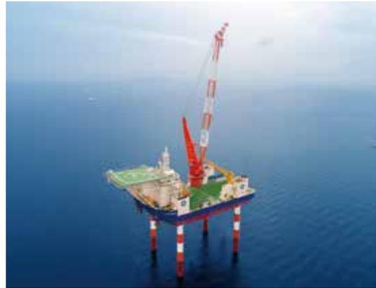
日本初の大型クレーンを搭載したSEP船。10 MW級の風車の設置が可能で、長尺レグにより水深50 mでのジャッキアップに対応している。
