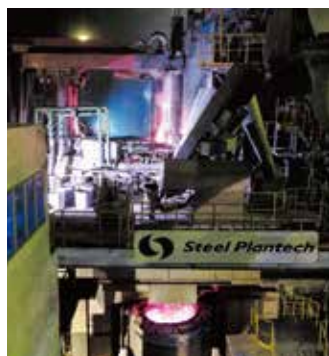
図6 シャフト直結型予熱炉の例(ECOARC™)
