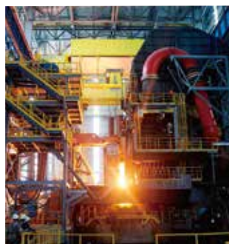
図5 フィンガーシャフト型予熱炉の例(Quantum)
