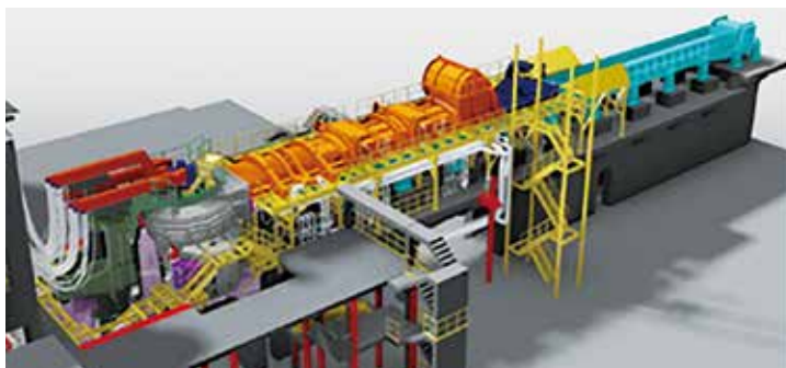
図4 水平コンベア型予熱炉の例 (Consteel ® )
