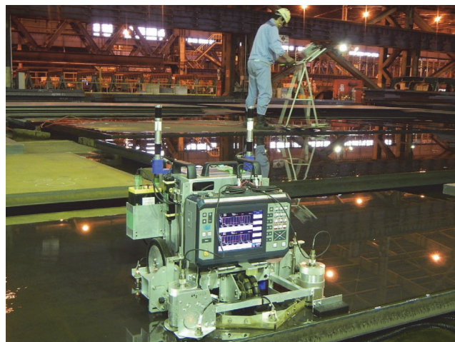
図16 厚板自走式超音波探傷ロボット (Online version in color.)
