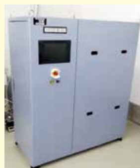
図9 バイオマスガスから発電する SOFC
