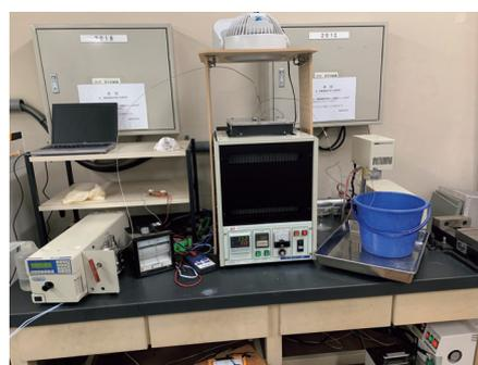
図1 超臨界水(高温高压の水)生成装置
